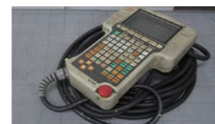
装置名 ティーチングペンダント メーカー名 那智不二越 型番 ROP500 故障症状 電源をONにしても画面が表示されない。
