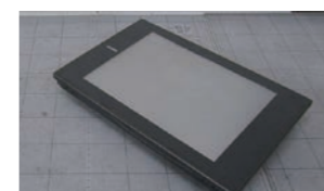
装置名 タッチパネル メーカー名 三菱電機 型番 A975GOT-TBA-B 故障症状 タッチが効かない。
