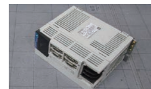
装置名 サーボドライバ メーカー名 三菱電機 型番 MR-J2S-40B 故障症状 E9が発生し、動作しない。
