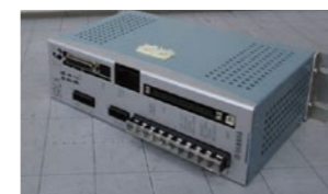
装置名 ロボットコントローラ メーカー名 ヤマハ発動機 型番 SRCX20 故障症状 通信エラー発生。
