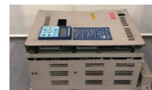
装置名 インバータ メーカー名 安川電機 型番 CIMR-H15WS 故障症状 FU (ヒューズ溶断) で異常発生。
