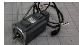
装置名 サーボモータ メーカー名 三菱電機 型番 HA-FF23 故障症状 AL.52 (誤差過大) のエラーが発生し、動作しない。
